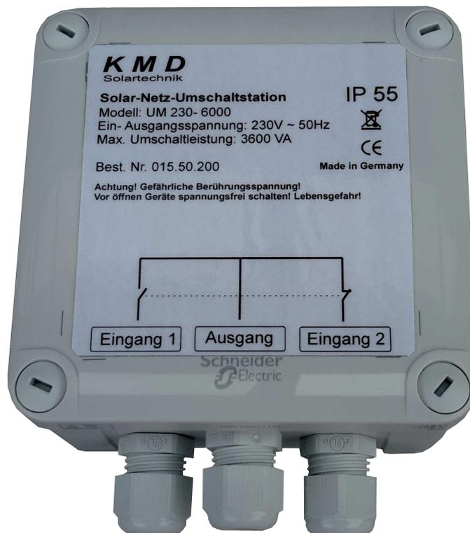
Die KMD Solar-Netz-Umschaltstation UM 230-6000 ermöglicht Ihnen einen problemlosen Betrieb an zwei verschiedenen AC Spannungen. Das Gerät schaltet automatisch nach Erkennung einer fehlenden oder fehlerhaften Versorgungsspannung um. Zum Umschalten wird hier ein Leistungsrelais hoher Güte verwendet, wodurch ein hohes Maß an Sicherheit durch den Kontaktabstand und Fremdspannung gegenüber Ihrem Wechselrichter gewährleistet ist.
