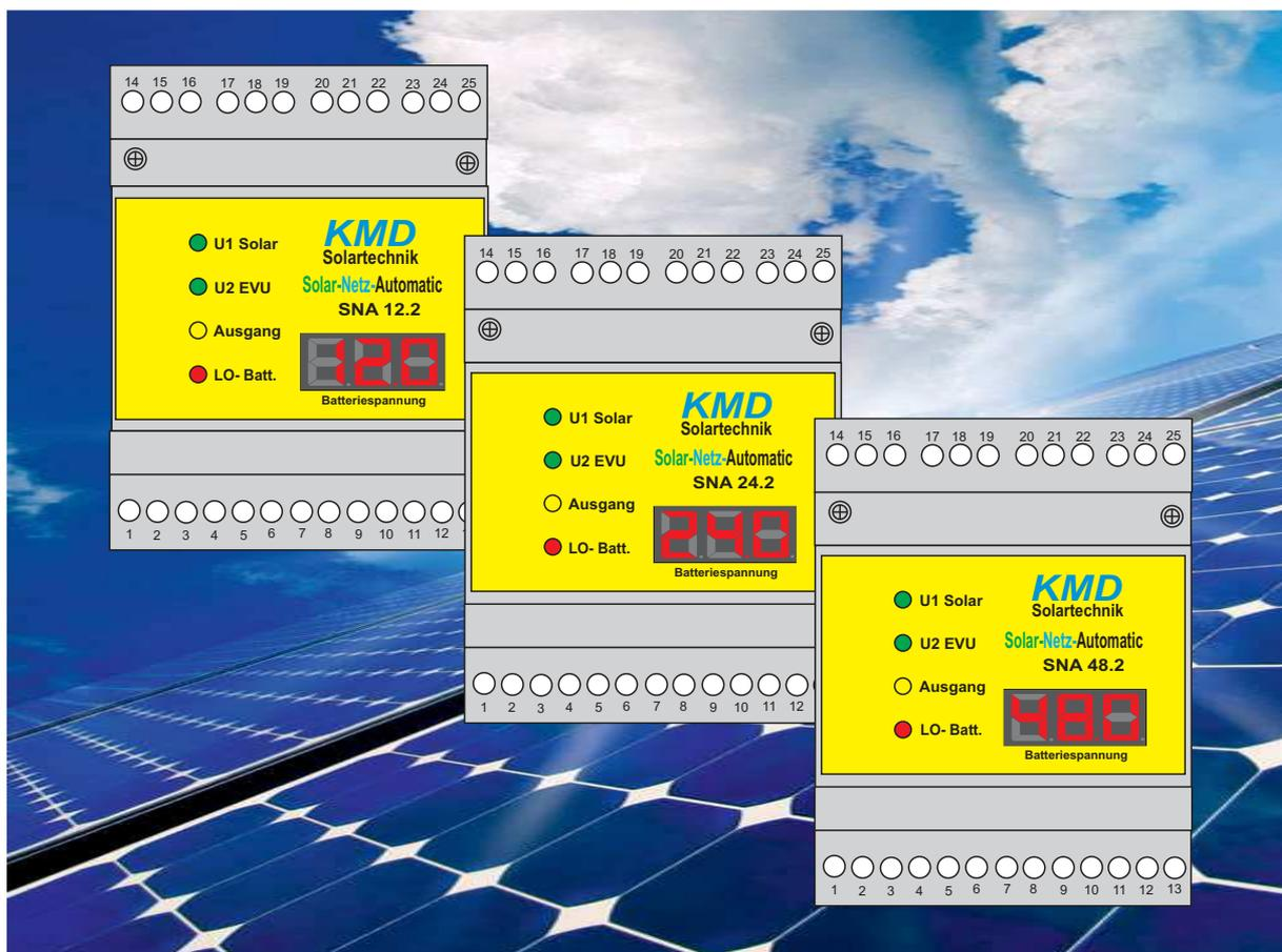
Die Umschaltautomatic SNA- Serie 2.0 ist speziell für Inselanlagen entwickelt worden. Mit dem internen Relais können Leistungen bis zu 1,8kW geschaltet werden. Durch die Verwendung eines ext. Leistungsrelais oder Schaltschütz ist die Umschaltleistung für die Inselanlage unbegrenzt. Die SNA 2.0 Automatic wird in Anlagen eingesetzt, wo bei sinkender Batteriespannung oder fehlender Solarenergie oder Netzspannung zwischen zwei Spannungen umgeschaltet wird.
